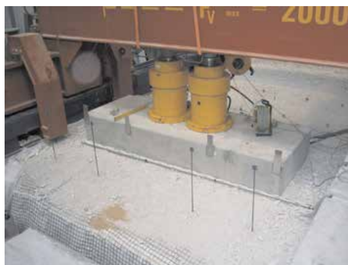
Rys. 17. Obciążenie 1,755 MN na belkę o wymiarach 1,0 m x 2,7 m za pomocą dwóch podnośników hydraulicznych [11]
